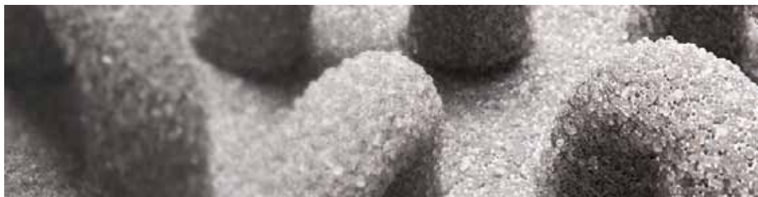
Adsorbent ma postać porowatych kryształków SiO 2 całkowicie nietoksycznych i nieszkodliwych dla środowiska
